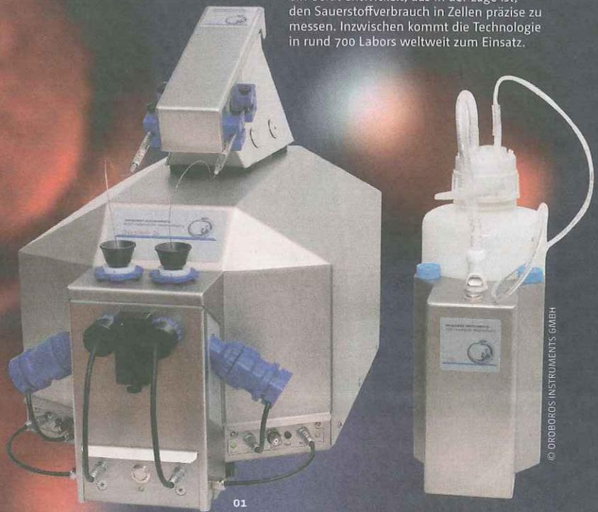
01 Mit dem Oxygraph-2k wurde erstmals ein Gerät entwickelt, das in der Lage ist, den Sauerstoffverbrauch in Zellen präzise zu messen. Inzwischen kommt die Technologie in rund 700 Labors weltweit zum Einsatz.
